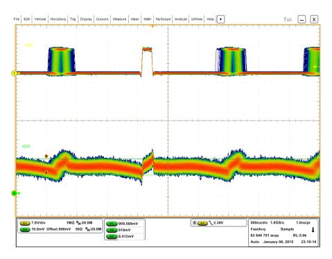
Load 0A Ripple: 8mV Load 20A Ripple: 8mV
