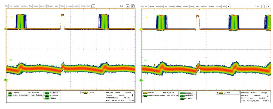
Load 0A Ripple: 8mV Load 20A Ripple: 8mV
